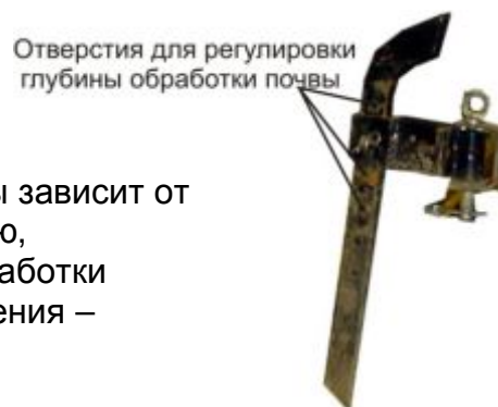
Рис. 8. Регулировка глубины обработки почвы
