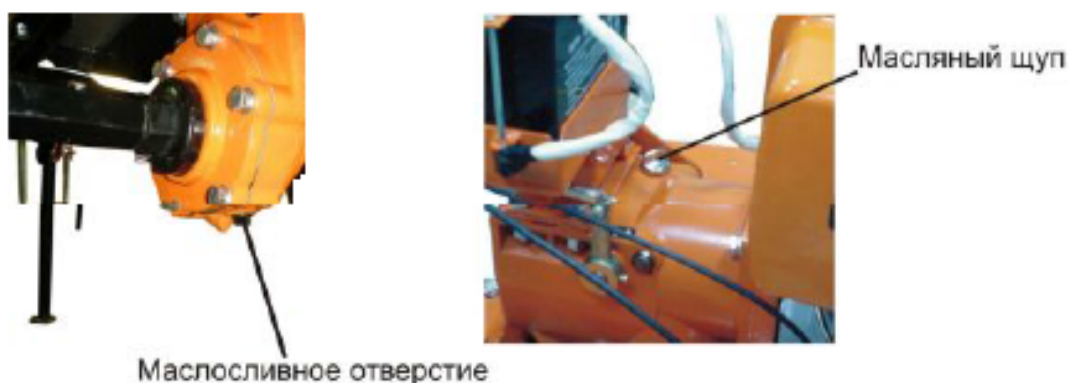
Рис. 6. Проверка уровня масла в основном редукторе и колесном редукторе мотокультиватора
